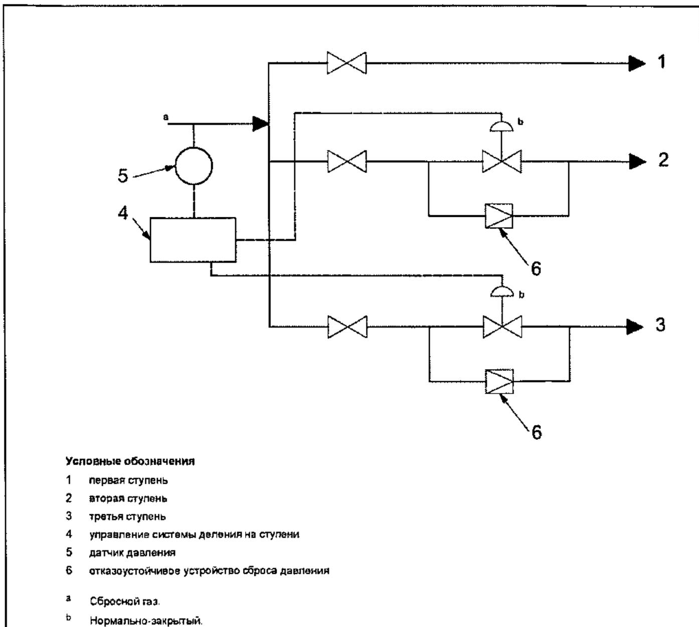
Упрощенная схема управления трехступенчатой
